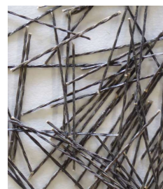
Mini Rebars gedreht
